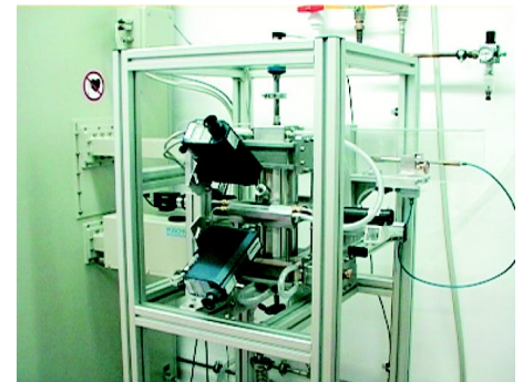
Bild 1. Der Mikrowellenofen mit Dilatometer
