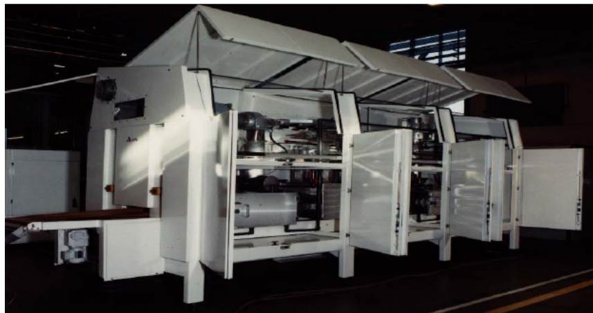
図8 スナックフード用マイクロ波パフイングシステム (APV Baker Ltd.のご厚意により掲載します)
