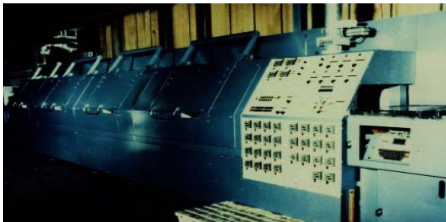
図9 ゴム加硫用のモジュールタイプ・マイクロ波予備加熱機 (Microwave Heating Ltd.のご厚意により掲載します)
