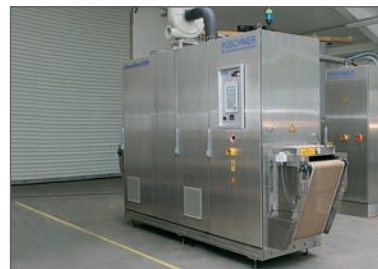
μWaveDryer1205型, 用于食品干燥, 通过红外线及蒸汽混合加热
