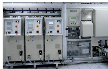
全自动多批量微波系统, 所干燥的过滤饼的水分含量将低于0.1%
