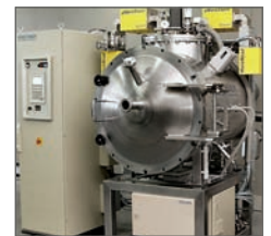
μWaveVac018-Sin型, 带红外阵列成像微波炉, 热腔, 混合可燃性气体如 N 2 , H 2 等, 石墨加热系充许温度高达 1600°C
