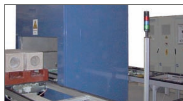
在生产流水线上使用30kW型烘箱, 可对中间有小孔的块状部件进行干燥处理
