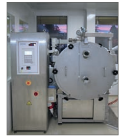
μWaveVac 0290型, 空气混合及真空圆盘干燥机, 符合防爆认证和药品优良制造规范 (cGMP, 美国)
