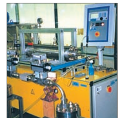
对有机物成分进行热化学转换的高压流水线式加热机 (250bar/350°C)
