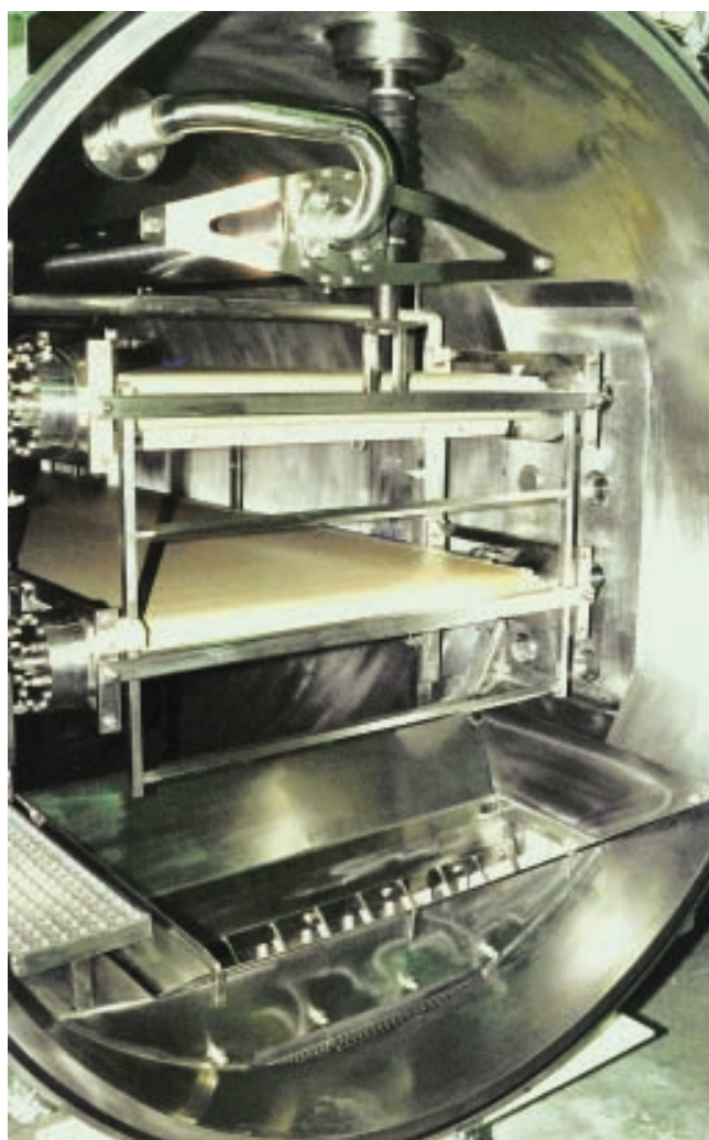
1: 2-Etagen-Vakuumtrockner mit Schwenkdüse zum Auftrag pastöser Produkte sowie Austrag mit Brecher
