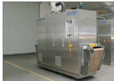
µWaveDryer1205 zur Trocknung von Lebensmitteln in Kombination mit Heißdampf und Infrarotheizung.
