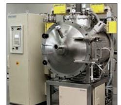
μWaveVac 018 Sin 赤外線 アレイカメラ、ホットキャピ ティ、N2、H2等のガス 雰囲気、1600°C までの グラフアイト加熱システム で構成されたマイクロ 波焼結炉
