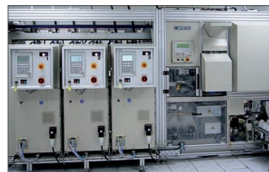
全自動バッチ方式マイクロ波 チェンバオーブは、残留湿度 0.1%以下での濾過ケーキ乾燥用
