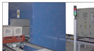
30 kW マイクロ波チェンバオーブ を装備した生産ラインは、 煙突プレハブユニットの乾燥用
