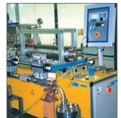
高圧フローヒーター 粘性の混合材料の 熱化学処理用 (250bar/400°C)
