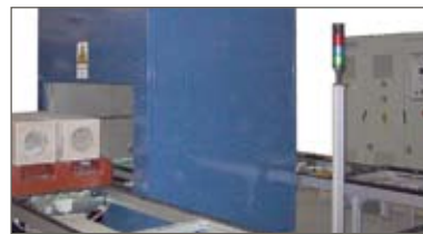
เตาอบไมโครเวฟขนาด 30 kW สำหรับอบแห้งวัสดุทำกล่องไฟ
