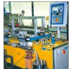
เครื่องทำความร้อนแบบท่อภายใต้ความดันสูงสำหรับแปรรูปสารอินทรีย์ (250 บาร์/350 °C)
