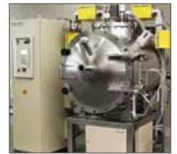
เตาเผาอินฟราเรดพร้อมกล้องอินฟราเรด (IR Array) สามารถทำงานได้ภายใต้บรรยากาศของก๊าซต่างๆ เช่น N 2 , H 2 และทำอุณหภูมิได้สูงถึง 1600 °C
