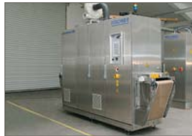
เครื่องอบแห้งอาหาร สามารถใช้ได้ทั้งกับการให้ความร้อนด้วยอินฟราเรดและไอน้ำ
